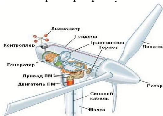
Рисунок 1. Ветрогенераторная установка для заряда аккумуляторных батарей
