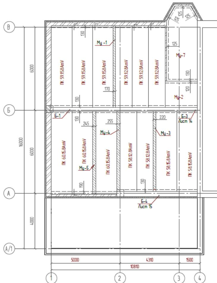
Спецификация элементов покрытия
