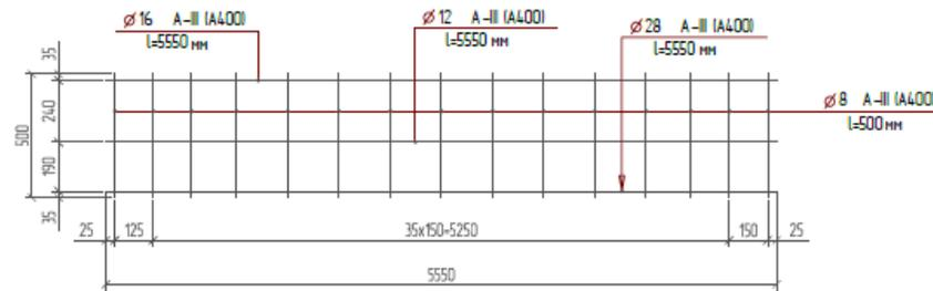
Спецификация элементов балки Б-3
