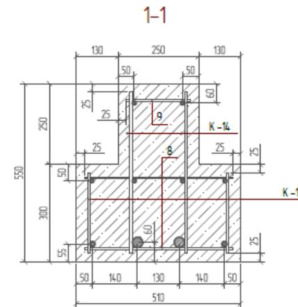
Спецификация арматурных изделий балки Б-2
