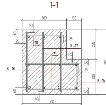
Спецификация элементов балки Б-4
