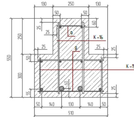
Спецификация арматурных изделий балки Б-3
