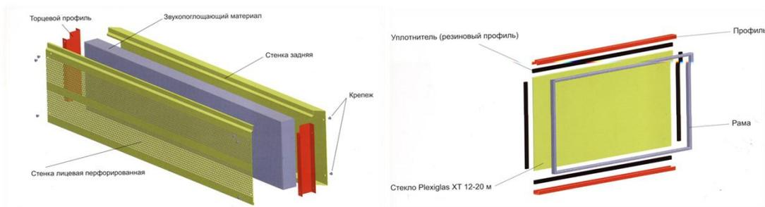
По окончании срока службы сваи, рамы и кассеты можно подвергнуть переработке с последующим использованием в качестве сырья для производства новых металлоконструкций. Используемая в качестве звукопоглощающего материала лиэстровая вата также подлежит переработке.
