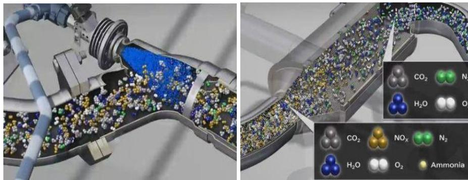
Рисунок 3 – Нейтрализация оксидов азота и окисления аммиака
