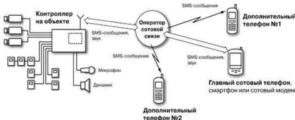
Рисунок 1 - Схема передачи информации в GSM охранной системе при использовании функции SMS.
