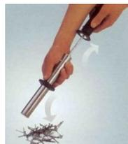
Щётка состоит из внутренней части профиля, в котором находится несколько магнитов и трубы. Вставив магнитный «сердечник» вовнутрь второй трубки, можно собрать стальной мусор с верстака или стола.
