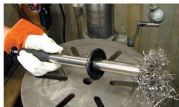
Создан магнитный инструмент (магнитный сборщик) для эффективного подбирания/сбора металлических частиц из трудно доступных мест, сыпучих материалов, гальванических ванн и т.д. С помощью общедоступных материалов его создание и применение.
