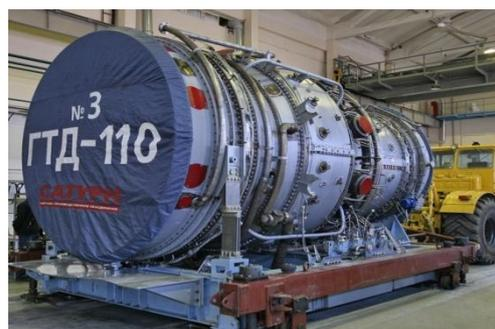
Рисунок 1 Газотурбинный двигатель ГТД-110
