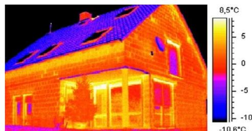
Результат обследования и СП 50.13330.2012 «Тепловая защита зданий» позволяют сделать вывод, нет необходимости в дополнительном утеплении. Термическое сопротивление "лего-блока" составляет  $3,4 \text{ м}^2\text{C/Вт}$ , а требуемое сопротивления теплопередаче стен жилого здания для Северо-Западного региона в
