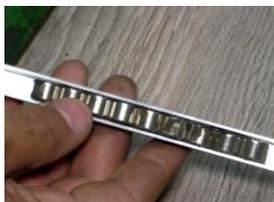
5. Заглушаем профильную трубку, в которую уложены магниты.
