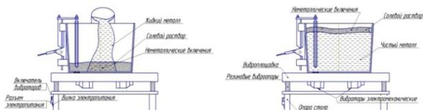
Рисунок 1- Схема заливки металла в расплавленную соль, подверженную вибрации
