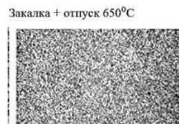
Рисунок 3 – микроструктура стали 10ХСНД после термического улучшения
