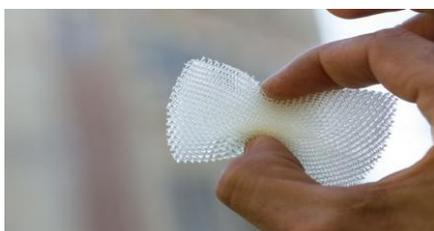
Рисунок 7 Сверхлёгкий материал «Микролаттис»
