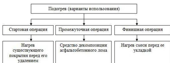
Рисунок 1 – Варианты использования подогрева при устройстве АГБС горячим методом
