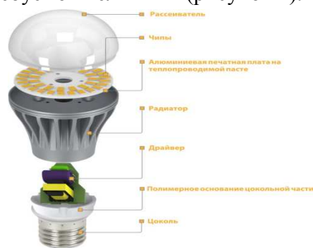
Рисунок 2 - Устройство светодиодной лампы
