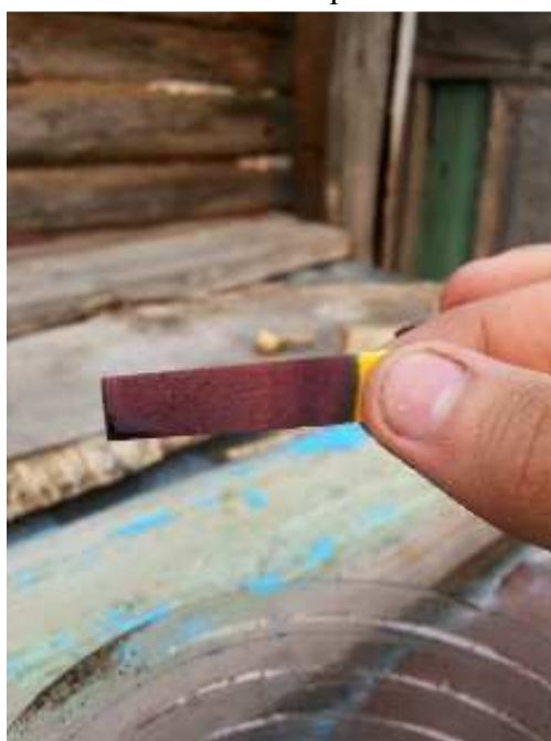
Рисунок 1 - pH-тестер указал на щелочную среду окрасившись в фиолетовый цвет.
