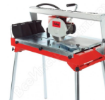
Станок для резки плитки и камня с водяным охлаждением
