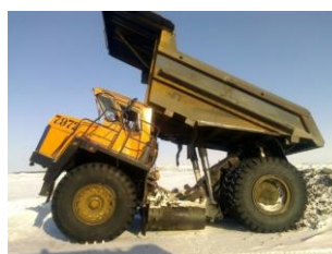
Рисунок 2. Последствия поломки продольных лонжеронов рамы.
