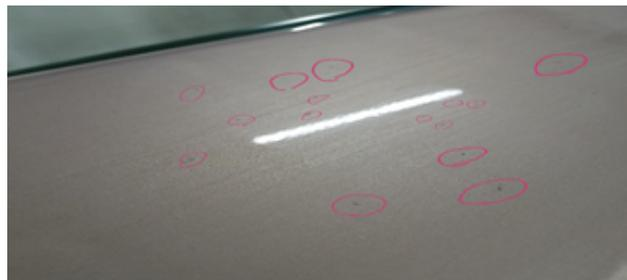
Рисунок 8. Значительные повреждения обычного ЛКП
