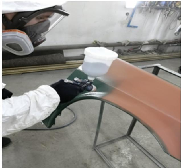
Рисунок 2. Процесс окрашивания детали в «Раптор»
