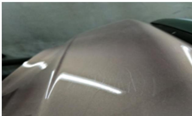
Рисунок 5. Видимые повреждения на обычном ЛКП
