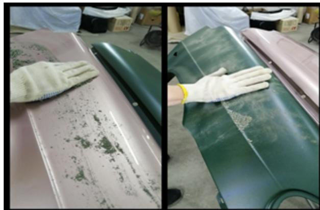
Рисунок 6. Попытка повреждения разных ЛКП с помощью камней
