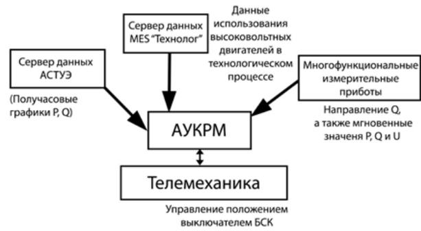
Рисунок 3. Планируемая архитектура автоматической подсистемы управления компенсацией реактивной мощности
