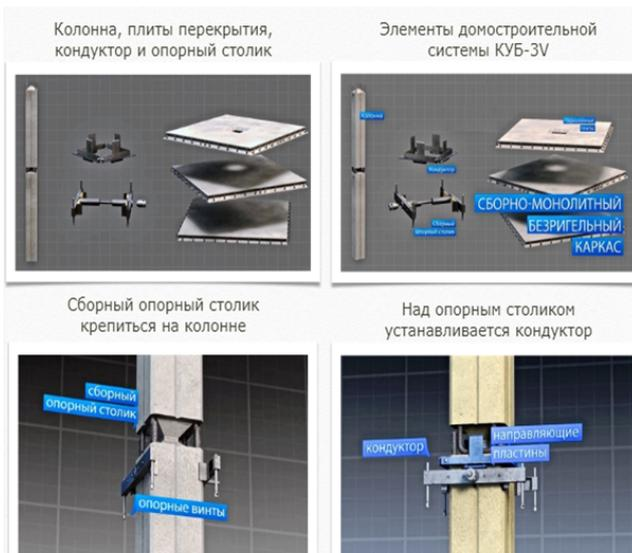
Рисунок 1. Элементы домостроительной системы КУБ-3V
