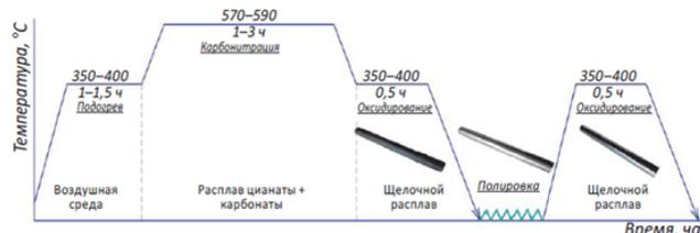
слой», под которым находится диффузионная зона, состоящая из твердого раствора углерода и азота в α-железе. Но часто наблюдается пятнистая поверхность из-за процесса окисления.
