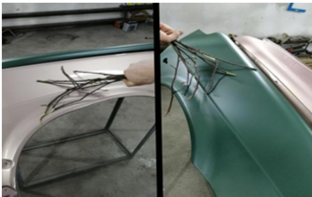
Рисунок 4. Попытка повреждения разных ЛКП с помощью веток
