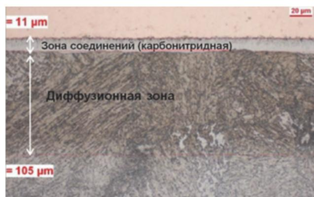
Рисунок 3. Типовая микроструктура стали после карбонитрации
