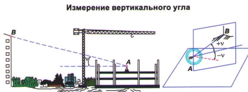
Рис. 14 Измерение вертикального угла
