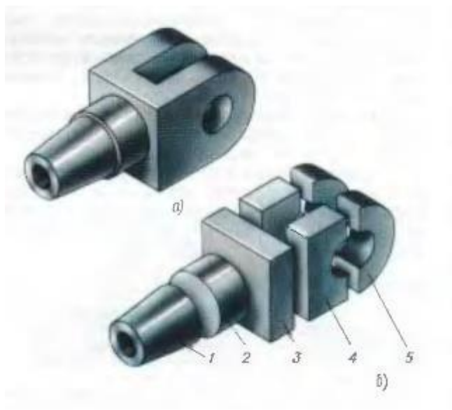
Рисунок 12 – Геометрические тела: 1- усеченный прямой круговой конус с цилиндрическим отверстием; 2- прямой круговой цилиндр; 3- прямоугольный параллелепипед; 4- два прямоугольных параллелепипеда с цилиндрическими отверстиями; 5- два полых полуцилиндра
