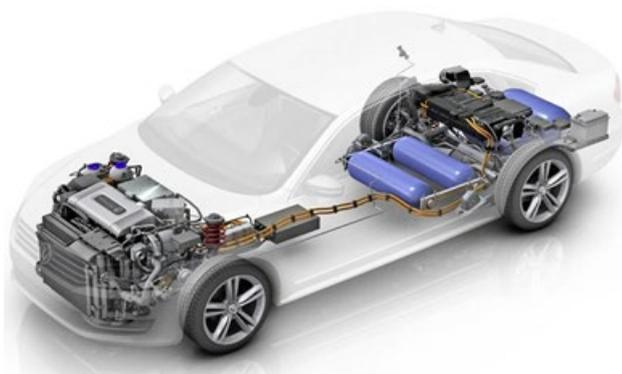
Рисунок . 5. Устройство водородной системы
