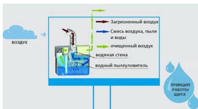
Рисунок 2. Устройство и принцип работы рекламного щита
