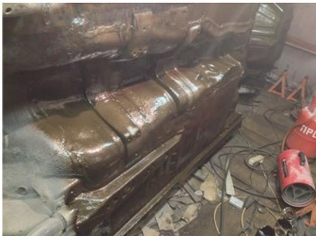
Рисунок 3. Обработка днища автомобиля отработанным маслом
