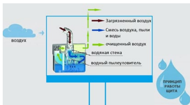
Рисунок 2. Устройство и принцип работы рекламного щита
