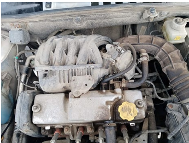
Рисунок 3. Фото системы вентиляции картерных газов автомобиля марки LADA после установки плавающего клапана и пяти лет его работы.
