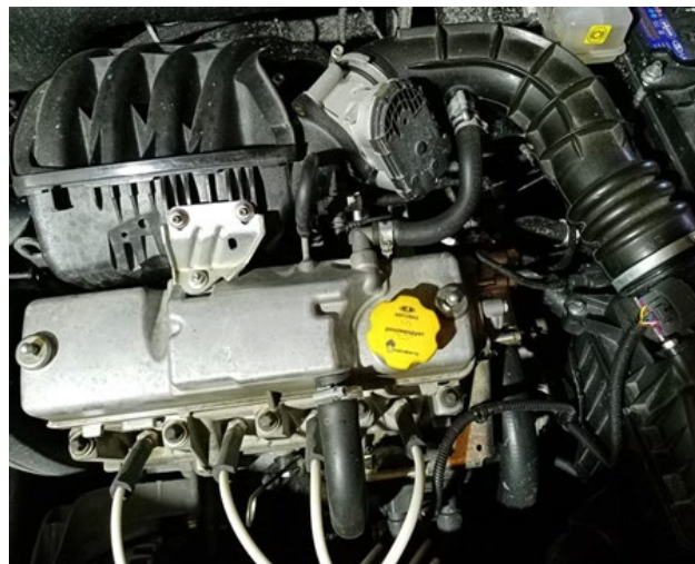
Рисунок 1. Фото системы вентиляции картерных газов автомобиля марки LADA до модернизации.
