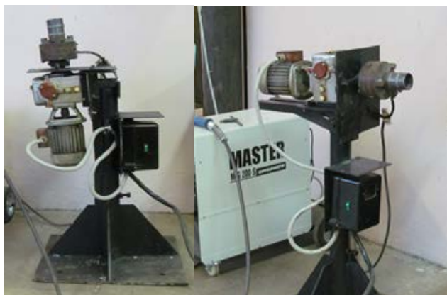
Рисунок 2 - Манипулятор для полуавтоматической, автоматической сварки кольцевых швов (труб) и наплавки на цилиндрические поверхности (валы, диски)
