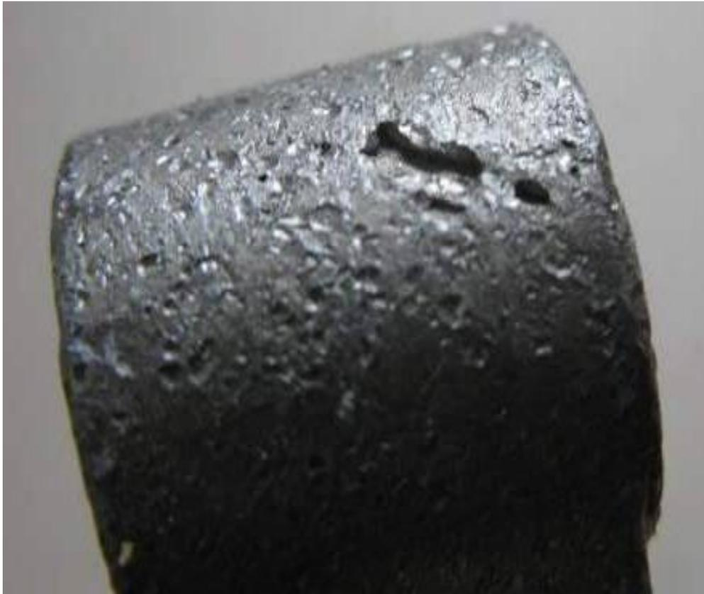
Рисунок 1 – Дефектная отливка
