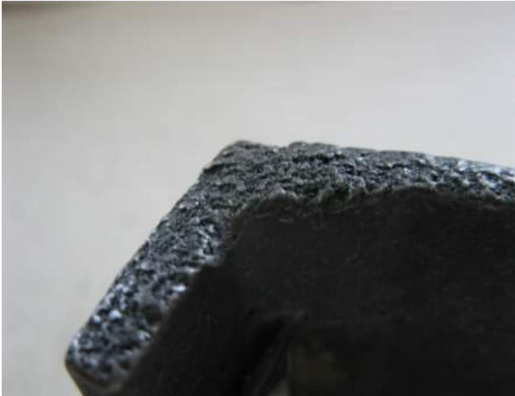
Рисунок 1- Дефектная отливка
