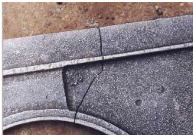
Рисунок 1- Дефектная отливка
