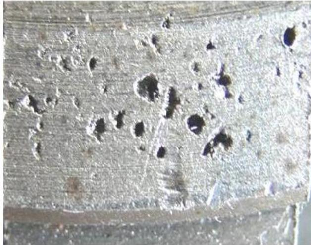
Рисунок 1- Дефектная отливка
