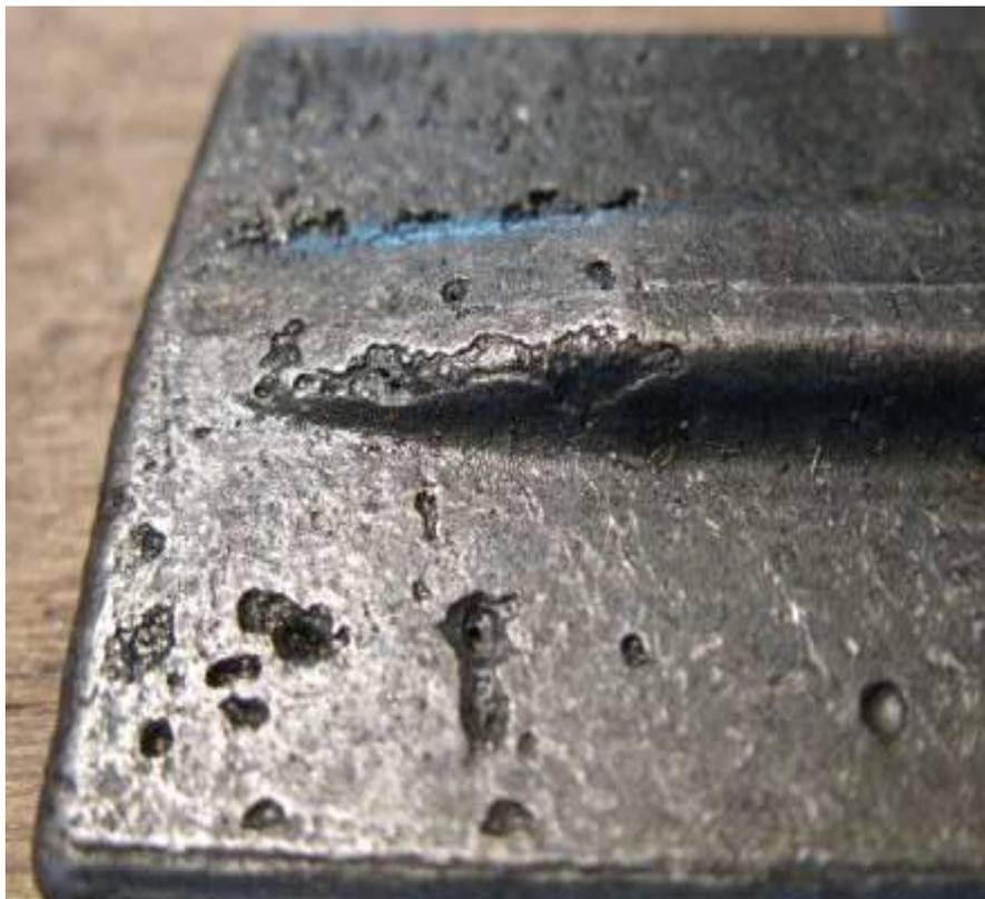
Рисунок 1- Дефектная отливка
