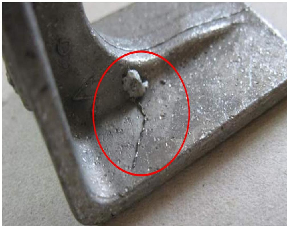
Рисунок 1- Дефектная отливка
