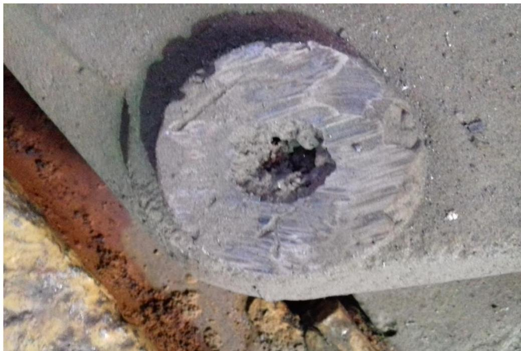
Рисунок 1- Дефектная отливка
