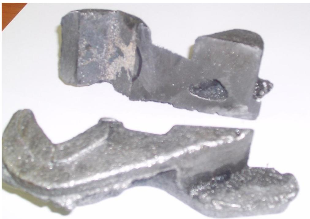
Рисунок 1- Дефектная отливка
