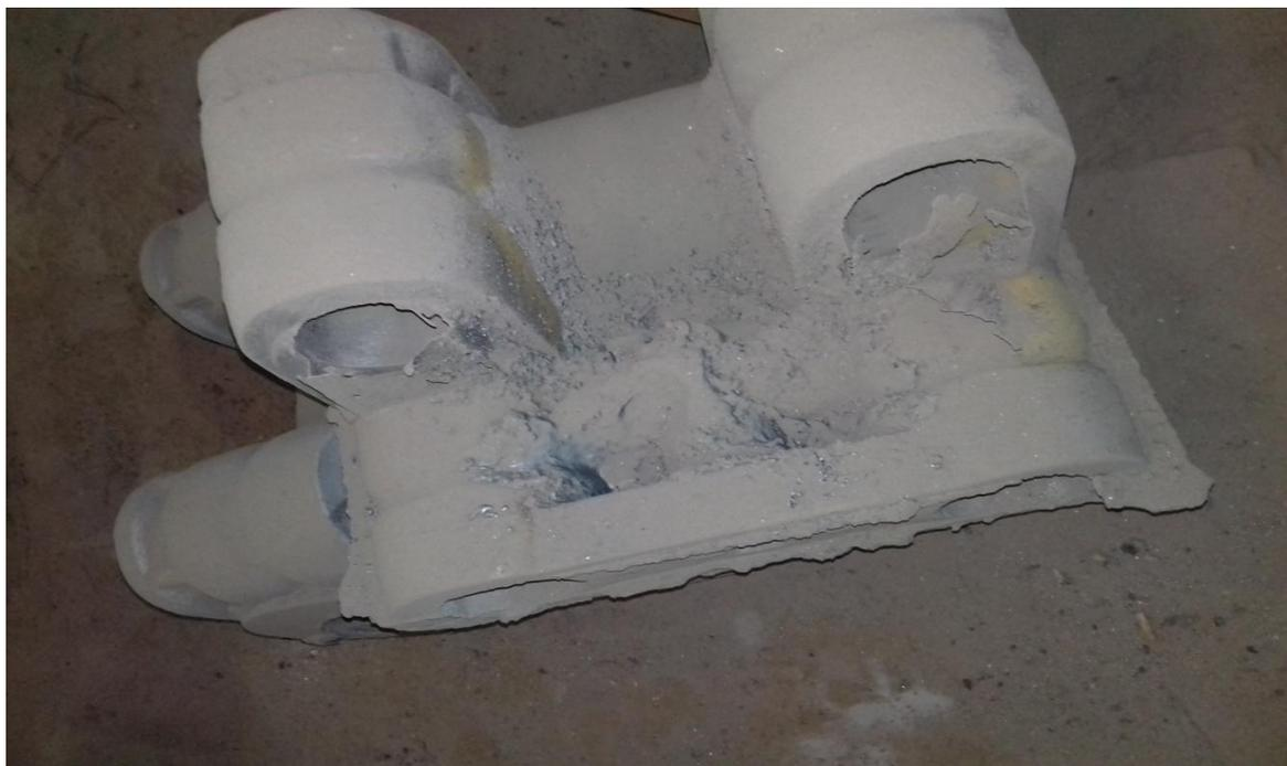
Рисунок 1- Дефектная отливка
