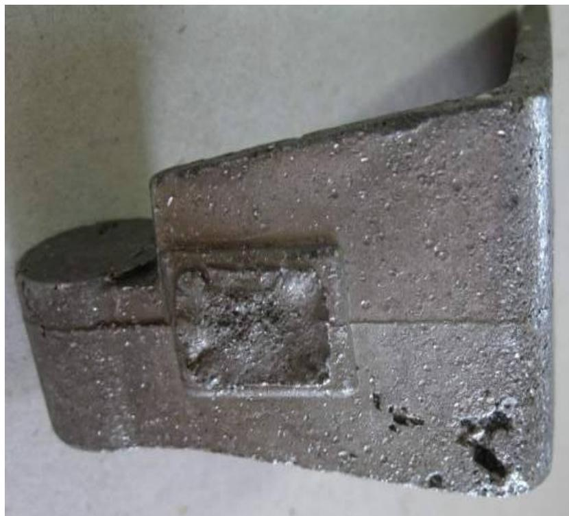
Рисунок 1- Дефектная отливка
