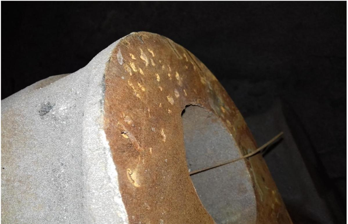
Рисунок 1- Дефектная отливка
