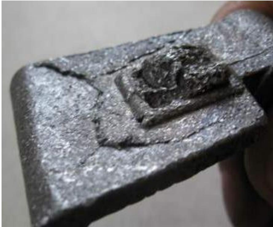
Рисунок 1- Дефектная отливка
