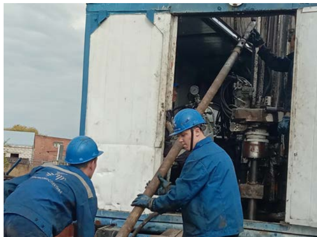
Рисунок 5. Спуск бурового снаряда
