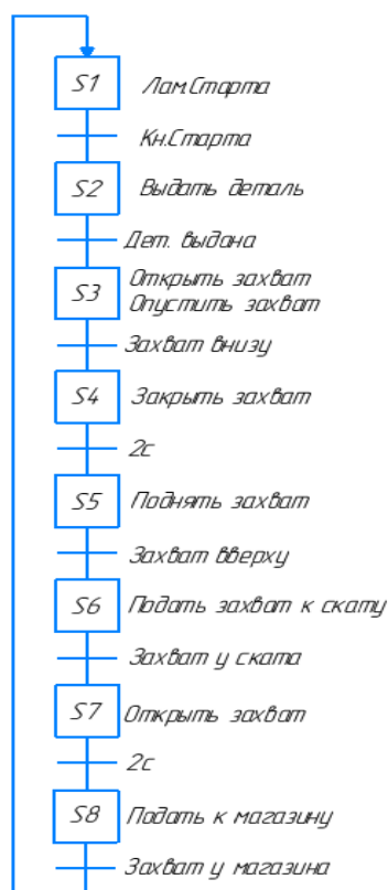
Рисунок 2. Алгоритм функционирования подъемно-транспортной станции
