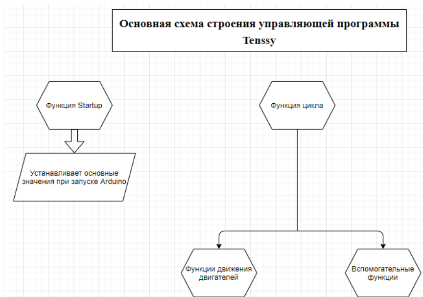
Рисунок 2. схема строения управляющей программы Tenssy
