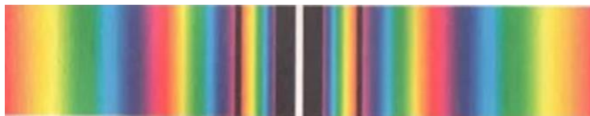
Рисунок 5 - Разложение белого света на составляющие в дифракционной решётке
