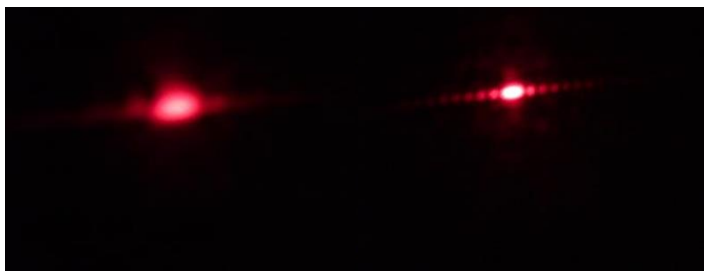
Рисунок 7 – Дифракция на щели 1 мм и 0,6 мм с расстоянием 4,82
