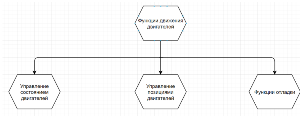
Рисунок 3 – схема функций движения двигателей
