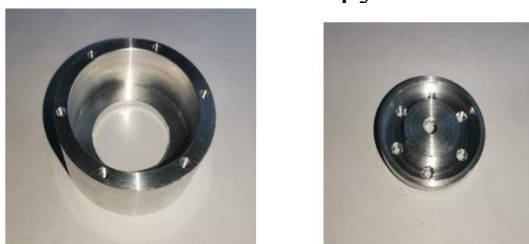
Рисунок 7. Алюминиевые детали робота, изготовленные на фрезерном станке с ЧПУ
