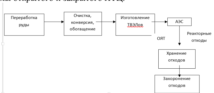
Рисунок 2. Схема потоков топлива и отходов открытого ЯТЦ
