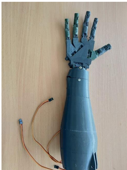
Рисунок 3 – Готовый модуль, полученный методом 3D-печати
