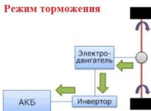
Рисунок 1 - Схема рекуперативного торможения
