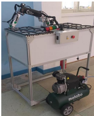
Рисунок 8. Собранная роботизированная установка для задач спектрометрии
