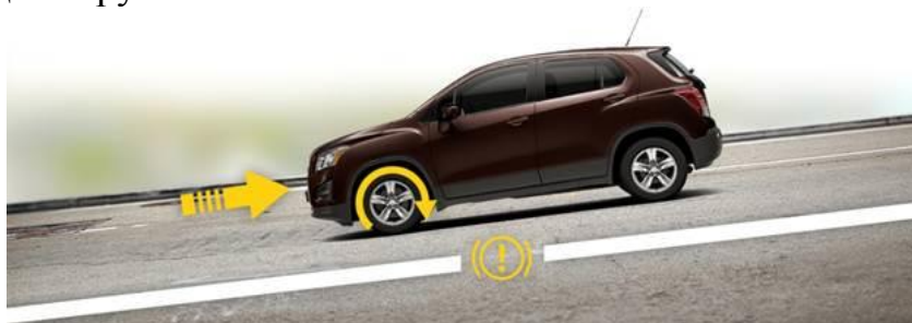
Рисунок 3 - система с электронным управлением, замедляющая скорость движения автомобиля на спуске
