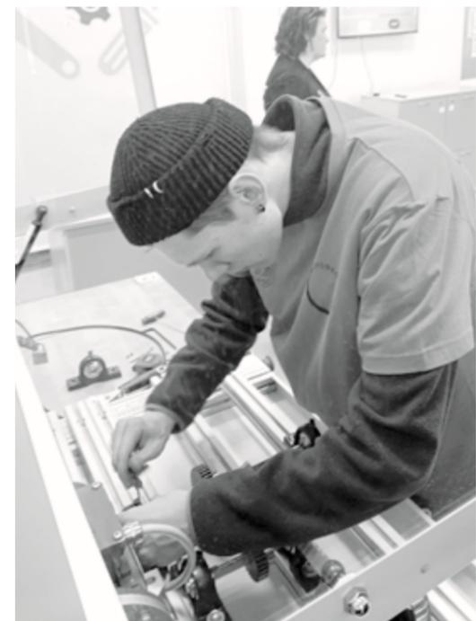
При выполнении модуля «Центровка валов и балансировка роторного механизма в собственных опорах» конкурсант производил изначально «грубую» центровку, измерял уровень вибрации, анализируя параметры вибрации и делая выводы по требуемым работам виброналадки и другие виды деятельности. Работа с приборами вызывала затруднения. У некоторых участников данные в приборах и письменном отчете не совпадали.
