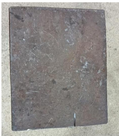
Рисунок 1 – Металлический лист 200×250 мм из отходов
