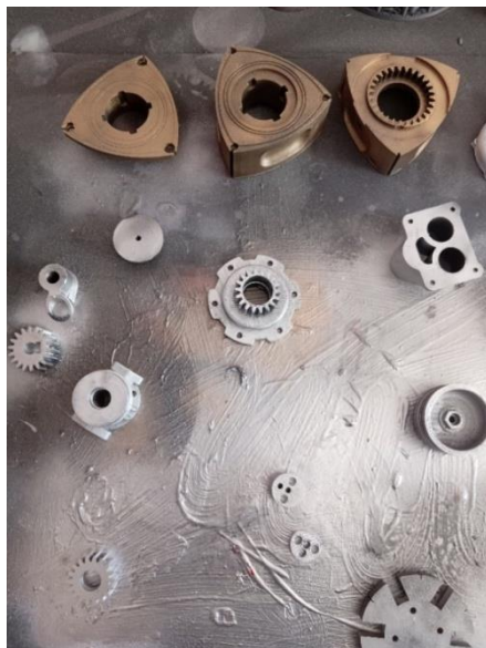
Рисунок-5 Распечатанные 3д модели, прошедшие финишную обработку
