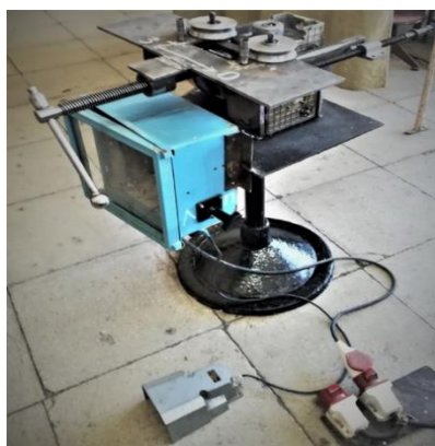
Рис. 1. Вспомогательное оборудование для механизации процесса гибки металлического профиля
