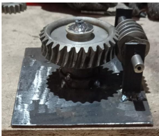
Рисунок 5 – Червячный механизм для поворота стрелы крана
