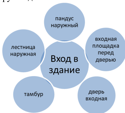
Рисунок 1- Элементы входа в здание
