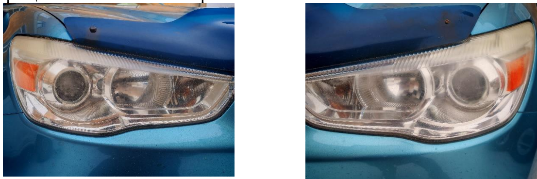
Рисунок 2-Помутнение рассеивателя фар ASX
