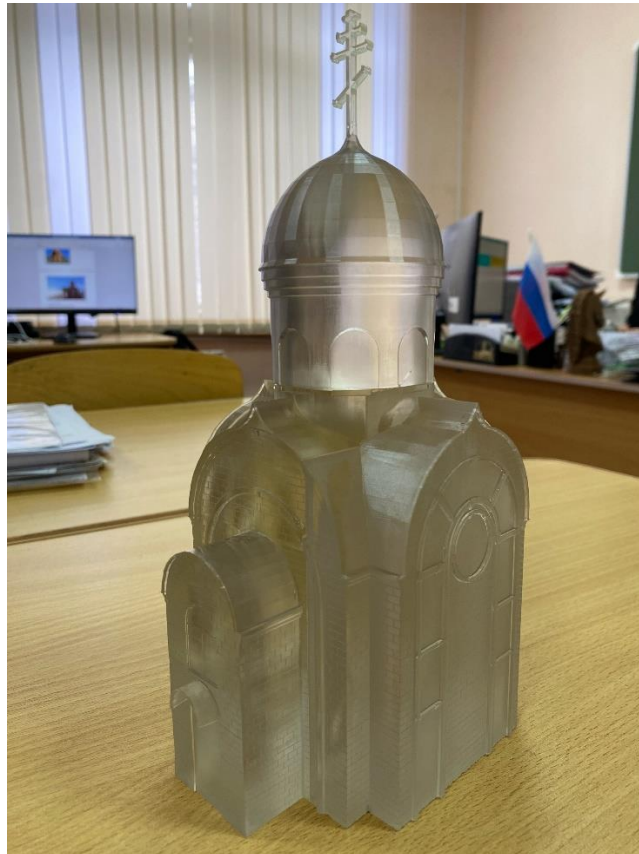
Рисунок 6 – Распечатанная на фотополимерном принтере
