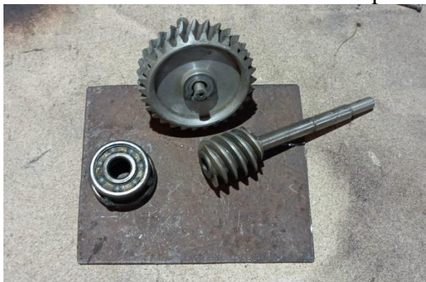
Рисунок 3 – Червячная пара и подшипник, бывшие в употреблении
