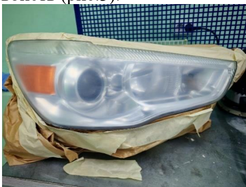
Рисунок 3-Снятие старого ЛКП с фар
